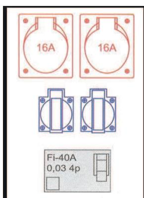
Elektro omara mora biti opremljena s FI stikalom z odklopilnim tokom 0,03 A. Zaščitena mora biti pred vremenskimi vplivi ( dež), podlaga pred omarico mora biti suha in izolirana z neprevodnim materialom – podestom (les, guma)
